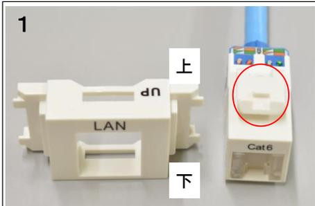
◆上図の向きでジャックをJISアダプタに取り付けます。
