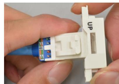
◆JISアダプタの上部、ジャックのキー部分をマイナスドライバーで押しながら外します。
