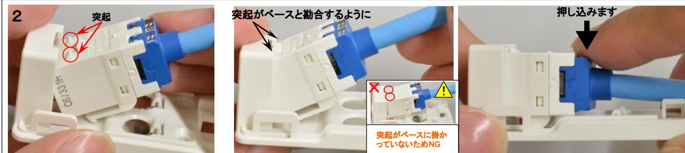
◆ジャックを成端した後、ベースにジャックを勘合させます。ジャック上部の突起がベースと勘合していることを確認して押し込みます。
