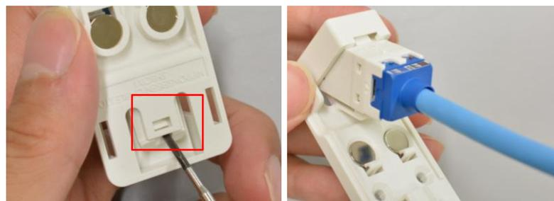
◆カバー、結束バンドを外し、ベース底部からジャックのキー部分をマイナスドライバーで押しながら外します。
