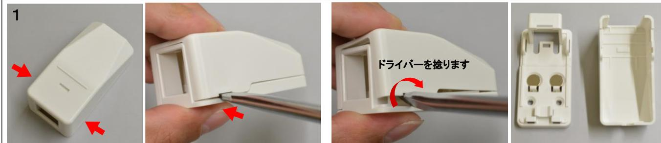
◆ボックス本体のベースからカバーを取外します。上図赤矢印の穴にマイナスドライバー(5.5mm以下)を挿し込み、カバーを外します。
