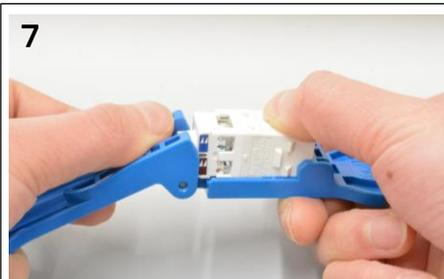
◆テコの原理を利用し、整線キャップと本体を勘合せさせます。
