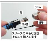
◆スリーブの平らな面を上にして プラグハウジングに挿入します。
