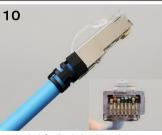
◆心線がプラグハウジングの先端 に到達していること、ブーツとプラグ ハウジングに隙間が無いことを確認
