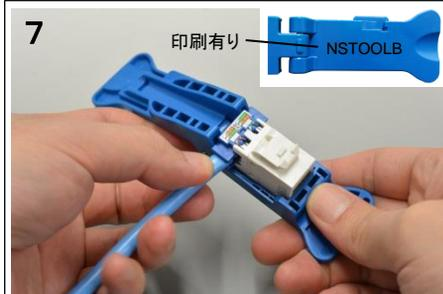
◆成端工具(印刷有り)に乗せます。
