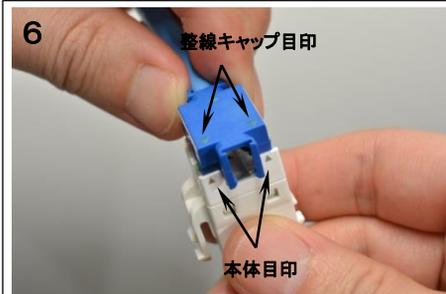
◆整線キャップと本体の目印を参考にして勘合向きを確認し、仮留めします。
