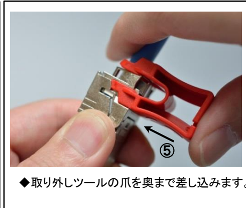
◆取り外しツールのSの表示が下側になるように持ち、しっかりとつまんでツールを開き、ジャックを挟みます。
