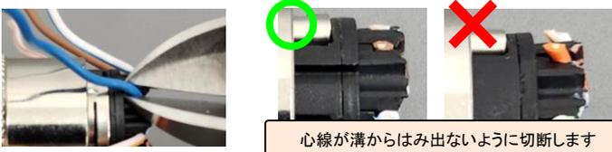
◆ニッパで余分な心線を切断します。溝端面に沿って切断してください。
