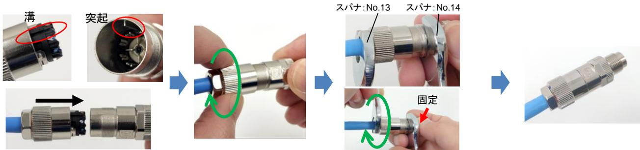
◆ワイヤーマネージャの溝と、フロントパーツの突起位置を合わせて挿入します。
