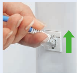
シャッターを押し上げる
