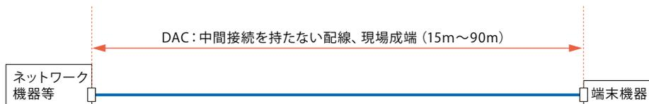
2台の機器を直接接続する配線構造
