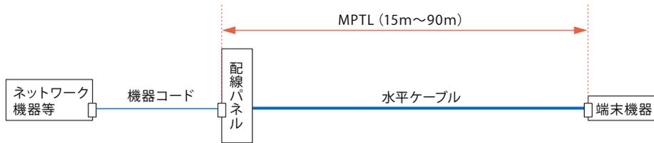
TO/SOおよびワークエリアコードの代わりに水平配線のデバイス側を直接モジュラープラグで成端する配線構造
