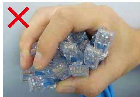
複数本のパッチコード配線作業時、プラグ部分を握った状態で作業をしないでください。プラグ同士の接触により、変形が発生する場合があります。
